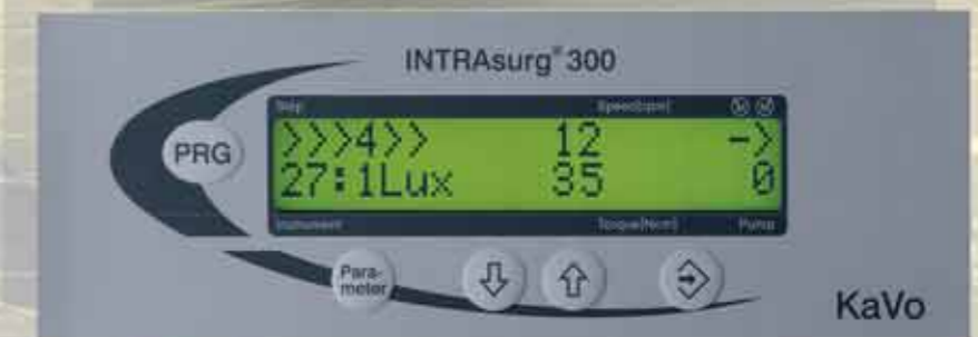
Programmebene: Kontrolliertes Einschrauben der Implantate.
