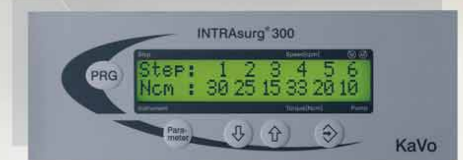
Programmende: Anzeige der maximalen Drehmomente zur Beurteilung der Primärstabilität.
